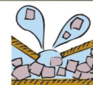
水の動きで、土の層が波打つたり穴が開いたり裂けてしまう。このため、地割れ、地面の波打ち、噴砂、陥没などの被害が発生する。
