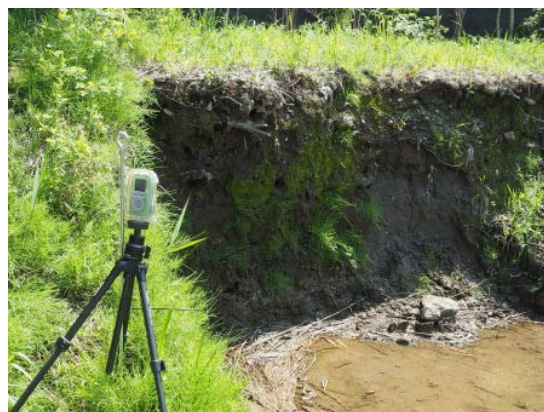
インターバルカメラの設置
