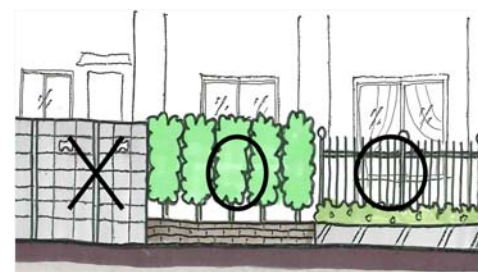
高いブロック塀よりも、低い塀や生垣、柵などが安全
